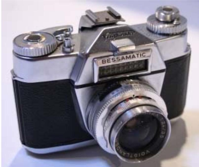
Bei der Voigtländer Bessamatic handelte es sich um eine mechanische 35 mm Spiegelreflexkamera deutscher Nachkriegsproduktion. Aufgrund ihrer technischen Ausstattung kann sie mit zu den besseren Erzeugnissen der damaligen Phototechnik gezählt werden.
